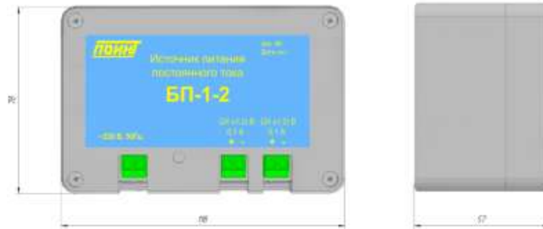
Рисунок 7.1 – Источник питания постоянного тока БП-1 в открытом исполнении
