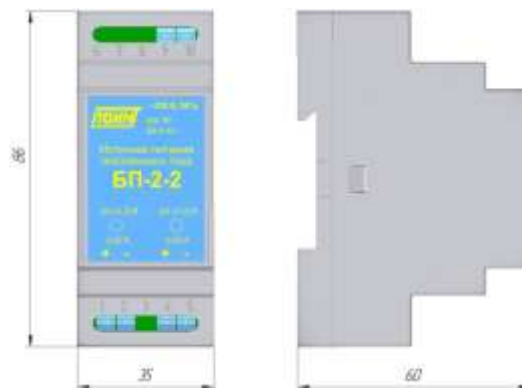
Рисунок 7.2 – Источник питания постоянного тока БП-2 двухканальный
